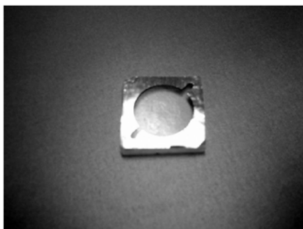
图 A.2 隔片放在溴化钾片上
